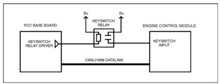
FIGURE 12. CONTROL SYSTEM BLOCK DIAGRAM
