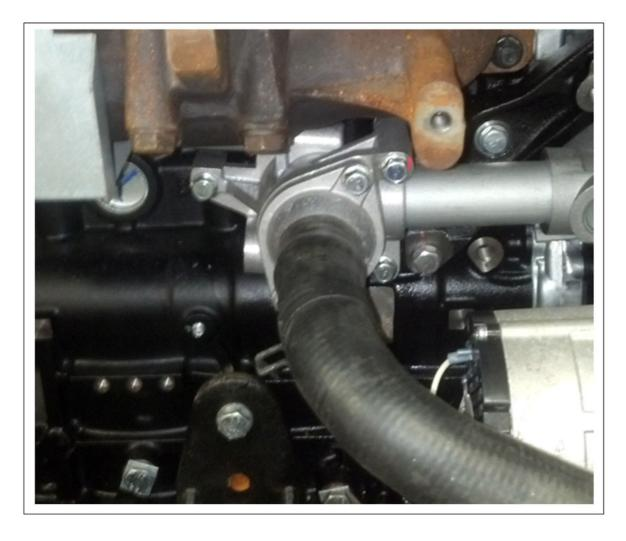
FIGURE 45. THERMOSTAT HOUSING LOCATION
