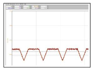
FIGURE 101. GOOD FUEL CONTROL EXAMPLE
