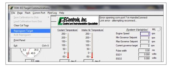
FIGURE 13. PULL DOWN REPROGRAM TARGET SELECTION
