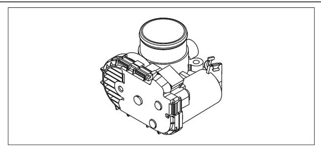
FIGURE 36. ELECTRONIC THROTTLE BODY (ETB)
