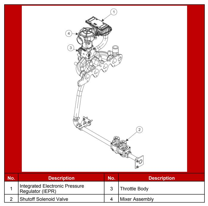
FIGURE 29. PROPANE VAPOR OR NATURAL GAS FUEL SYSTEM
