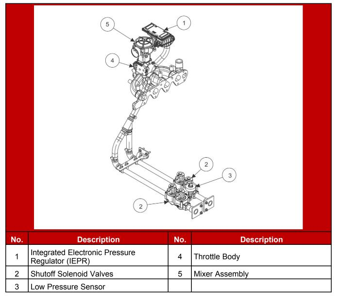
FIGURE 30. DUAL FUEL NATURAL GAS AND PROPANE VAPOR FUEL SYSTEM
