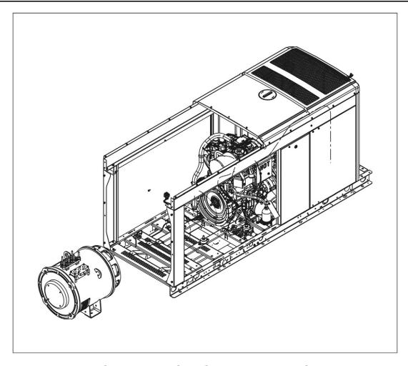
FIGURE 95. MOVING THE ALTERNATOR
