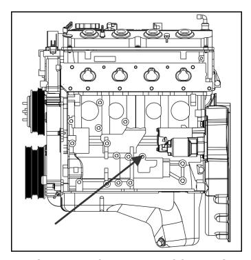
FIGURE 56. CYLINDER BLOCK PLUG
