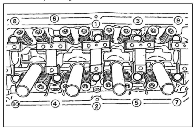
FIGURE 79. TORQUE SEQUENCE
